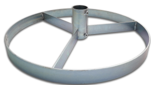
Base a sezione circolare realizzata in ferro piatto zincato a caldo. Spessore 3 mm, altezza 5 cm, diametro 62 cm, per palo diametro 48/60 mm, altezza bicchiere 14,5 c...
